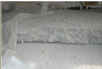
Panneaux semi-rigide de ouate de cellulose
